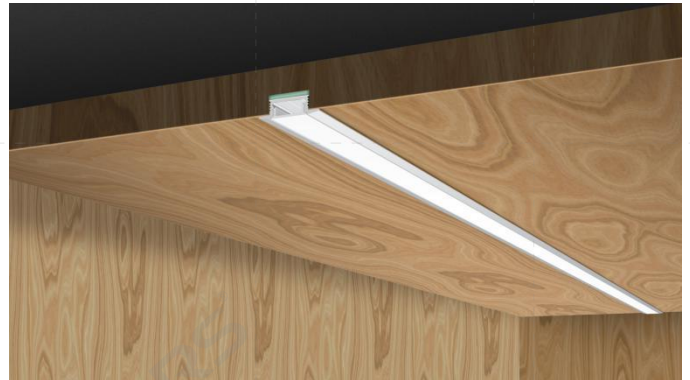
应用案例: 家具层板 开孔: 宽 18*深 7mm 玻璃胶固定
